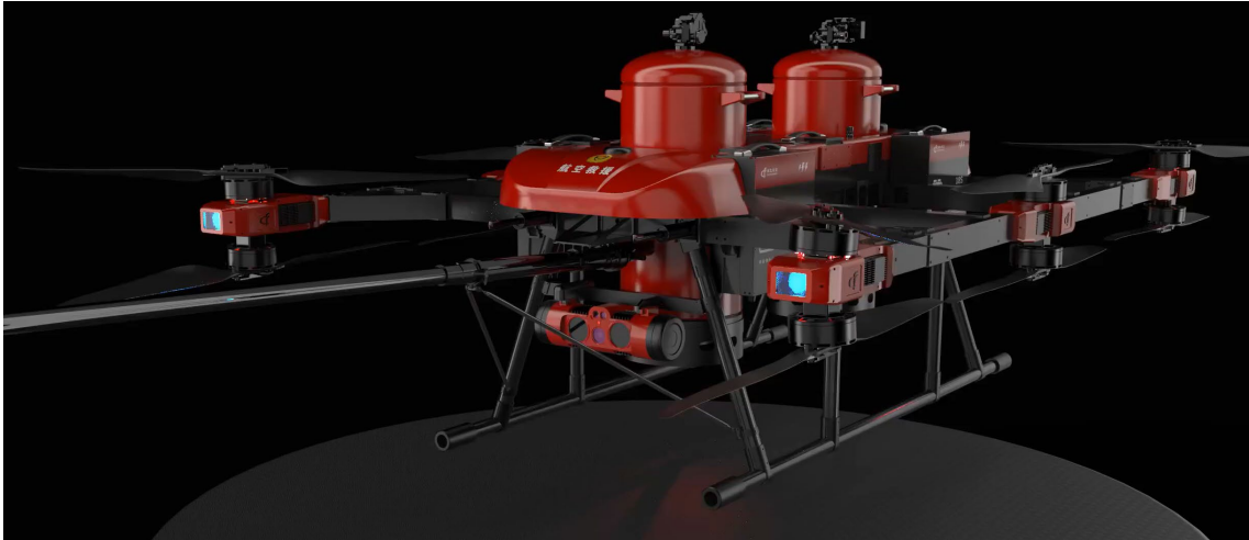
Figur 4-6 Slokkedrone fra Guofei-UAV. Bilde benyttet med tillatelse av produsent.
