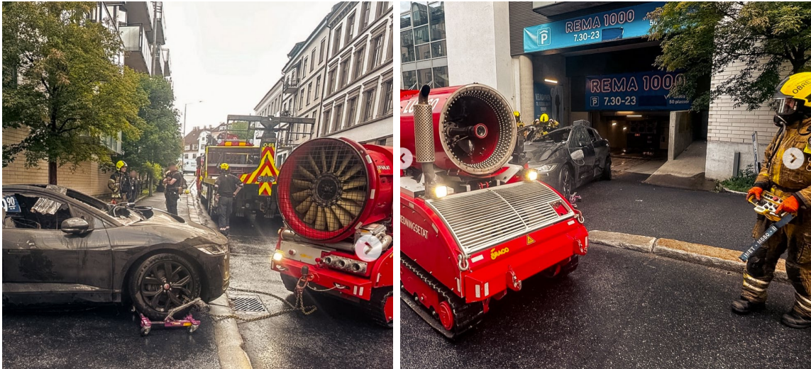
Figur 4-4 Situasjonsbilde der en elbil ble trukket ut fra en parkeringskjeller ved hjelp fra en fjernstyrt robot av type LUF60. Foto: Oslo brann- og redningstjeneste.
