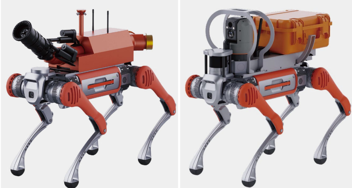
Figur 4-5 Eksempel på robothunder fra Unitree – slokkeapplikasjon til venstre, søk-og redning til høyre. Bilde gjengitt med tillatelse fra produsent.
