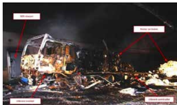
Utbrent vogntog i Oslofjordtunnelen 23. juni 2011. (Foto: Politiet).
