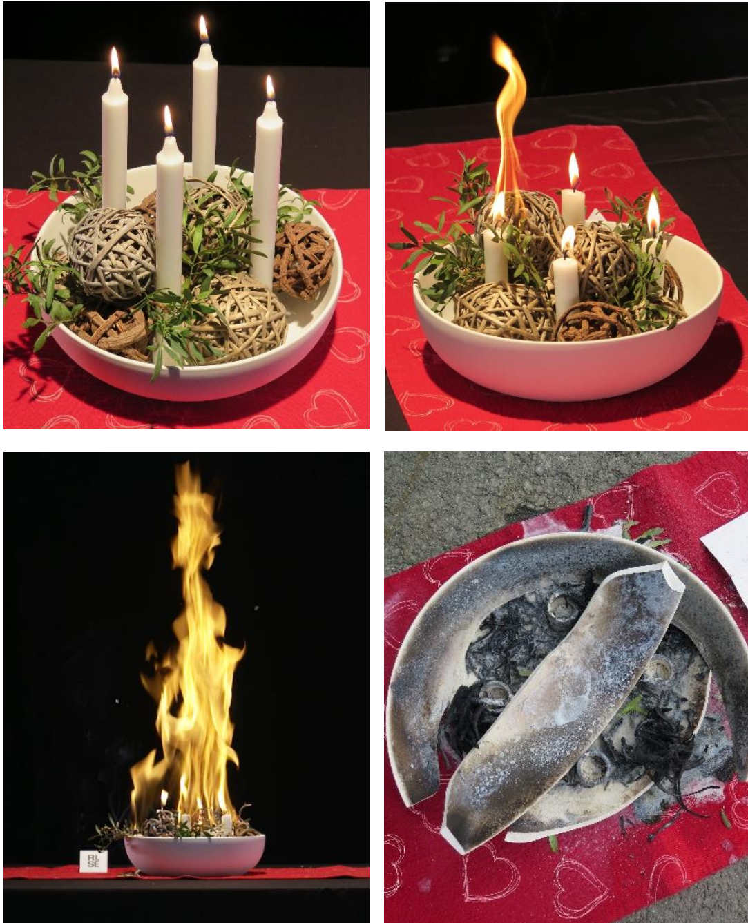
Figur 2-1 Demonstrasjon av levende lys plassert nær grener og barkballer. Bildet øverst til høyre er tatt like etter den første barkballen tok fyr. Bildet nederst til venstre viser de høyeste flammene observert i forsøket. Bildet nederst til høyre viser restene av dekorasjonen etter brannen ble slukket. Foto: RISE Fire Research/ Screen Story.
