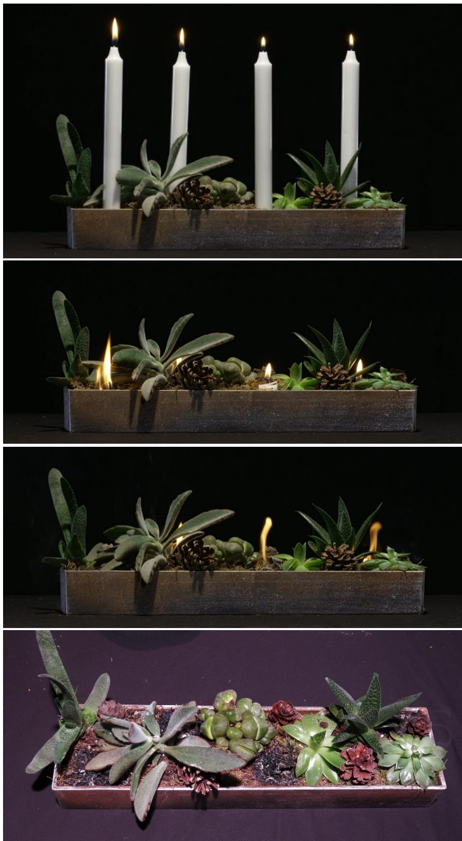
Figur 2-7 Levende lys nær brennbare naturdekorasjoner anbefales ikke. Selv om brannen slokkes av seg selv i dette tilfellet, er likevel enhver brann farlig. Foto: RISE Fire Research /Screen Story.
