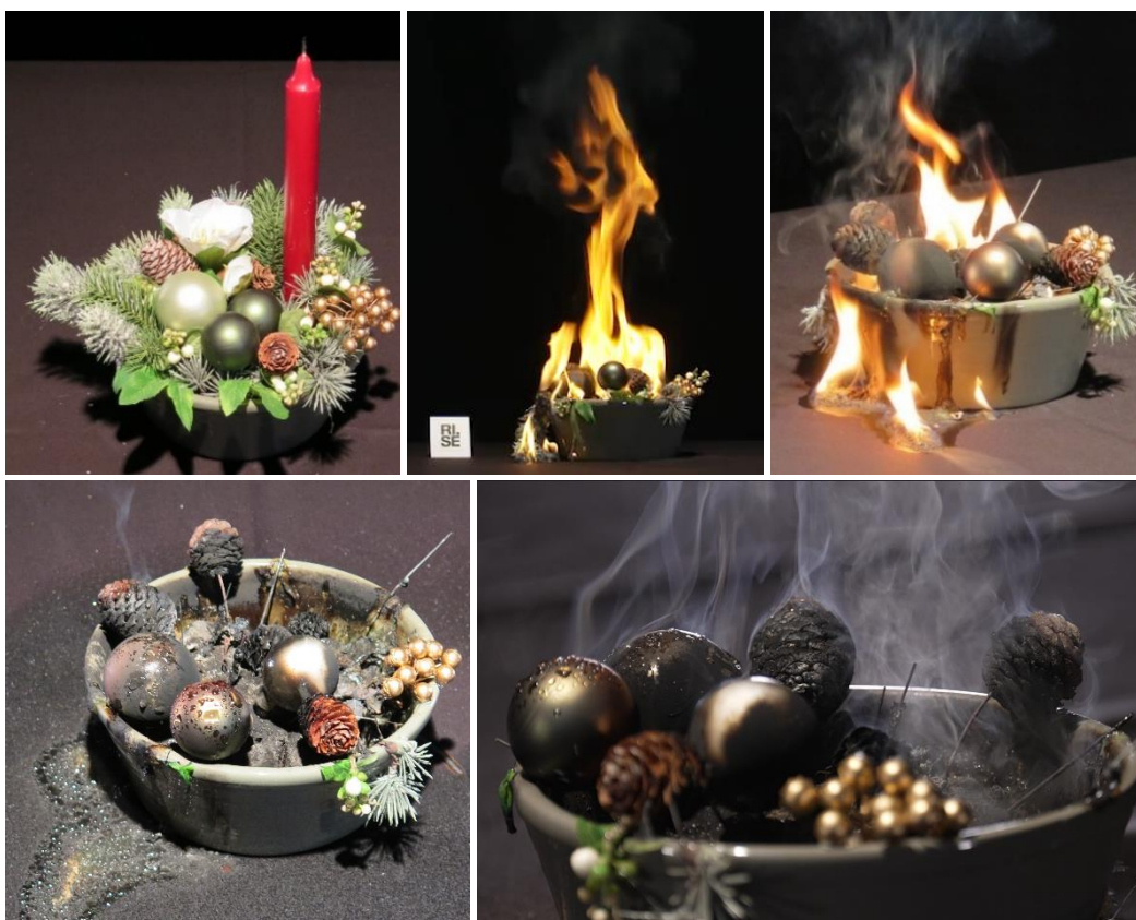
Figur 2-9 Levende lys nær brennbare plastdekorasjoner kan føre til raske og intense brannforløp. Bildet øverst til høyre viser dekorasjonen før tenning av lys. Bildet øverst i midten ble tatt da flammene var på det høyeste. Bildet øverst til høyre viser slutten av forsøket, da brannen i skålen hadde roet seg litt og flammene spredte seg utover duken. Bildene nederst viser dekorasjonen etter den ble slukket. Foto: RISE Fire Research/Screen Story.
