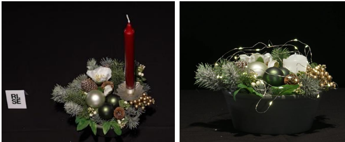
Figur 2-10 Tryggere (venstre): Lysholder i metall og ingen dekorasjoner som når over den øvre kanten til lysholderen. Anbefalt tryggere alternativ (høyre): LED-lys nær brennbare naturdekorasjoner. Foto: RISE Fire Research/ Screen Story.
