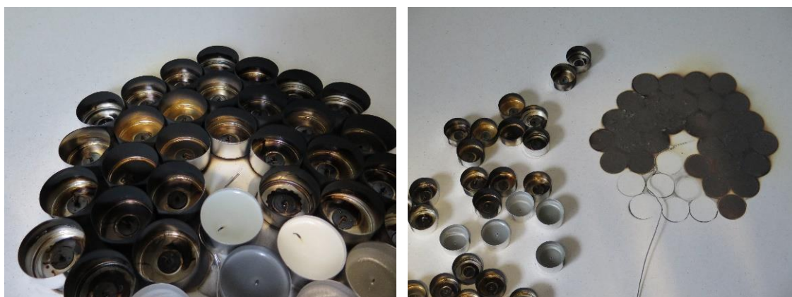
Figur 3-8 Case F (parafin i metallbeger) etter forsøket. Det var vesentlige varmeskader på underlaget. Noen lys sluknet i starten av forsøket, og hadde derfor mye parafin igjen i begeret.
