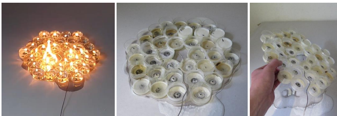
Figur 3-6 Case E (stearin og plastbeger) under og etter forsøket. Flere av plastbegrene smeltet og brennende stearin rant utover.
