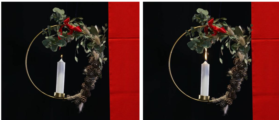
Figur 2-3 Pynt med dekor som henger over et levende lys. Bildet til venstre er tatt rett etter lyset ble tent, mens bildet til høyre er tatt to sekunder senere. Den røde sløyfen hadde begynt å smelte, og den smeltede plasten dryppet ned på lyset, hvor flammen ble kraftigere i kontakt med plasten. Foto: RISE Fire Research/ Screen Story.
