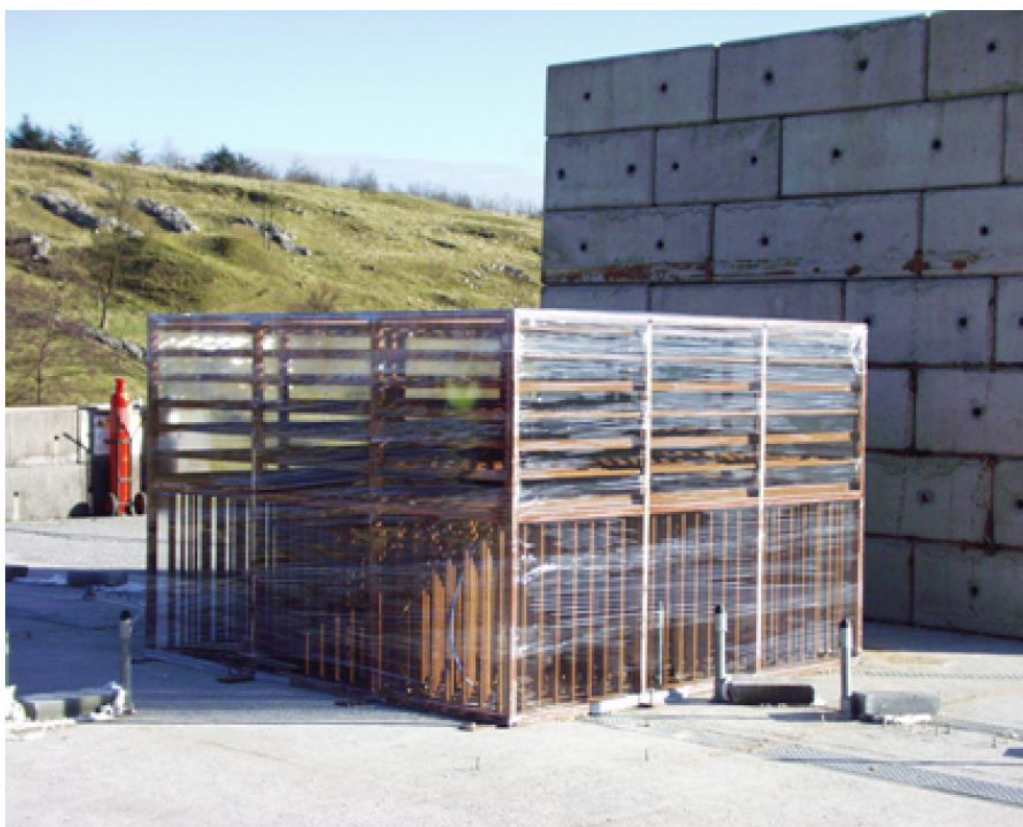
Figur 3-1 Fortettet område med rør i regulært grid med høy tetthet brukt i eksperimentet, ref. /9/.
