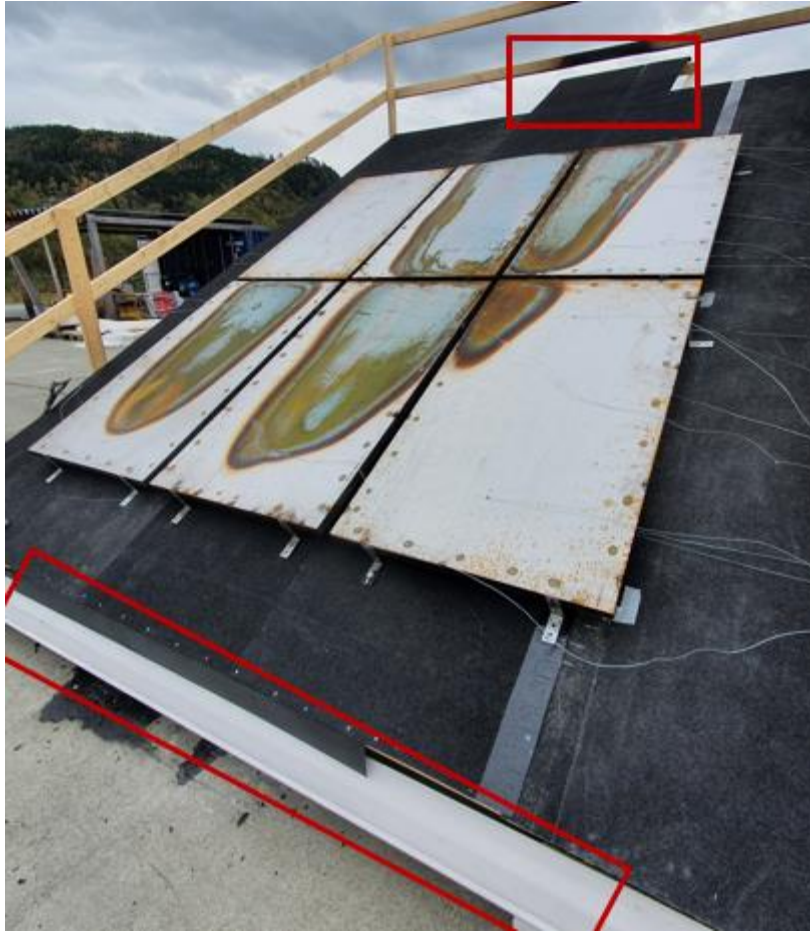
Figur 2-9 To endringar vart gjort i oppsettet av forsøket F2 i stor skala i forhold til forsøk F1. Taket vart utvida 1 m oppover i ei breidde på 1,3 m på midten av taket, og det vart montert ei takrenne under nedre kant av taket for å samle opp smelta takbelegg. Desse endringane er markert med raude firkantar på bildet.
