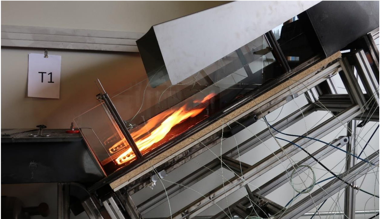
Figur 2-1: Forsøksoppsettet som er brukt til forsøka i liten skala. Dette er basert på utstyret som er skildra i CEN/TS 1187, testmetode 2 [8], med tillegg av ei stålplate som skal simulere ein solcellemodul plassert over takoverflata . Biletet er tatt under forsøk T1 med solcellemodulen plassert 12 cm over takoverflata, og med ein vindstyrke på 2 m/s.
