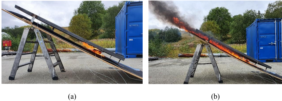
Figur 3-5 Brannen i forsøk M4 med UL-krybbe og solcellemodul. Bilde (a) er teke omkring 4 minutt etter forsøkstart og viser brannen i trekrybba før den har spreidd seg oppover takoverflata. Bilde (b) er teke omkring 16 minutt etter forsøkstart, og viser brannen då den hadde spreidd seg oppover heile lengda av takoverflata.
