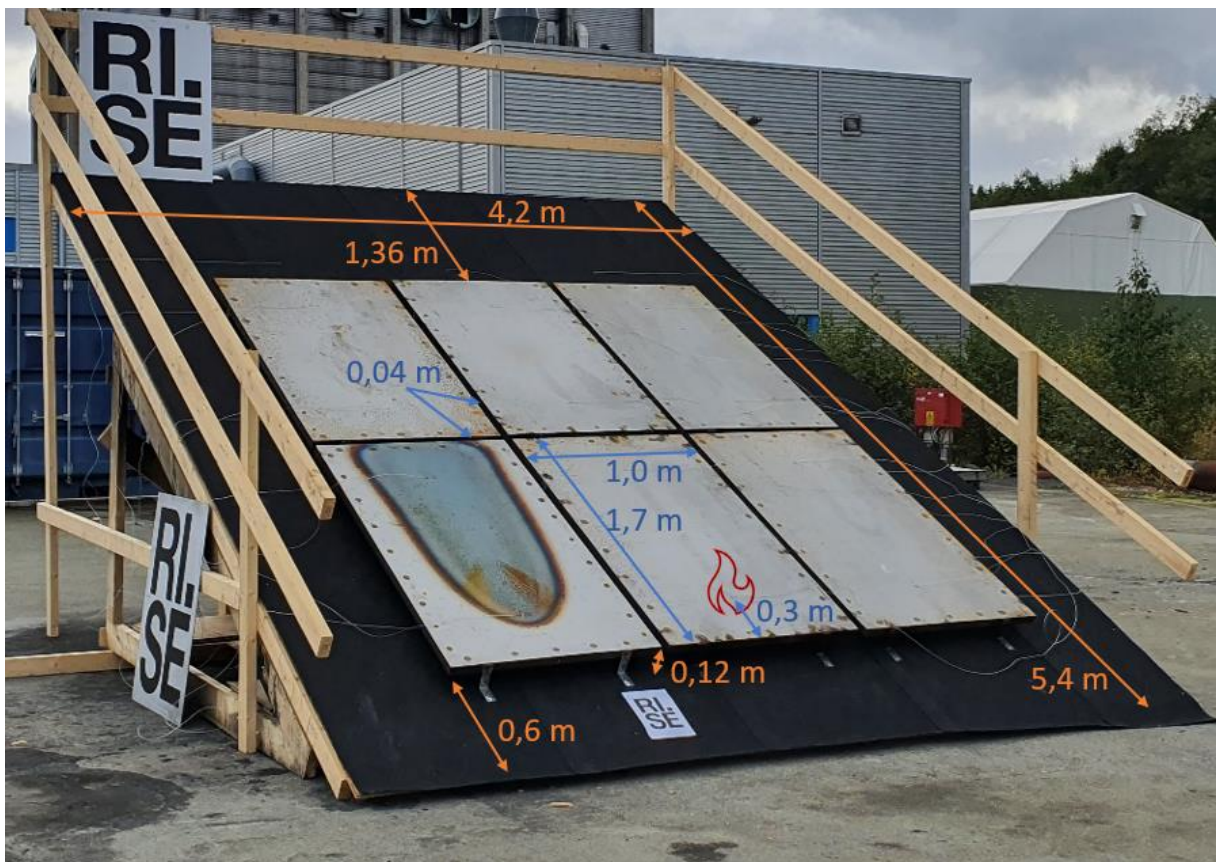
Figur 2-8: Storskala forsøksoppsett med takflate 4,2 m bredde x 5,4 m lengde og 30° takvinkel. 6 simulerte solcellemodular i stål er montert 12 cm over takoverflata. Startbrannen var plassert 0,3 m inn under midten av solcellemodulen nedst i midten, som markert på bildet.
