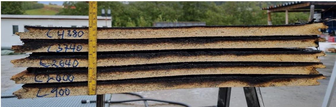
Figur 3-15 Djupn av forkolning av sponplatene er målt langs senterlina av taket ved dei same punkta som temperaturmålingane er gjort, 90 cm, 200 cm, 264 cm, 374 cm og 438 cm. Biletet viser snitta av sponplatene i forsøk F1.
