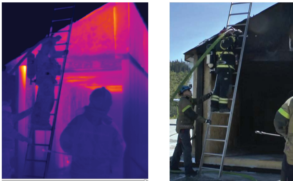
Figur B-11 Test 2B – Slokking på loftet måtte gjøres fra sideveggen. Selv om dette var noe mer tidkrevende enn å borre fra korridoren, ble brannen raskt slokket ved denne innsatsen. Å gjøre det på denne måten i en virkelig situasjon er nødvendigvis ikke så lett, der har man kanskje ikke så god tilgang til loftet som akkurat her.
