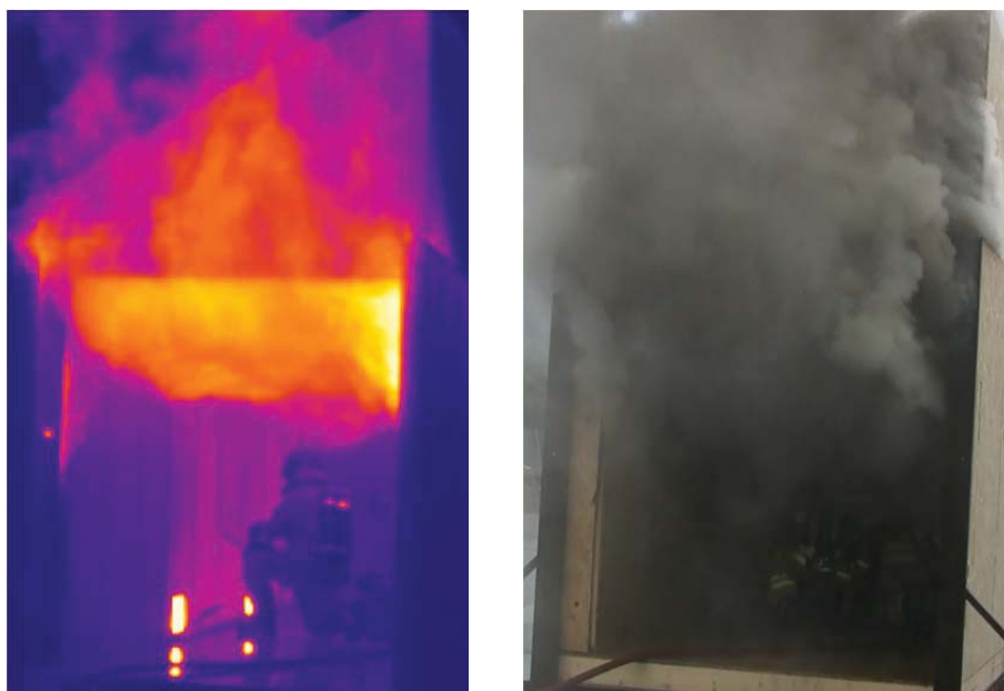
Figur B-23 Det ble sagt hull lavt nede på veggen, der røyktettheten var mindre.
