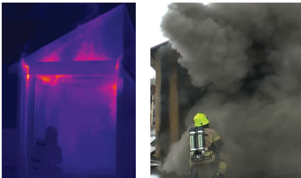
Figur B-16 Test 4B – Bildene er tatt etter at brannvesenet har startet slokkingen. Vann er spylt opp i taket og på vegg. Dette ble gjort for å hindre overtenning. Spylingen har imidlertid gjort at brannen i vegg er nesten umulig å oppdage både ved IR-kamera og ved øynene. Spylingen i tak og vegger bidrar i liten grad til å slokke selve brannen i hulrommet.
