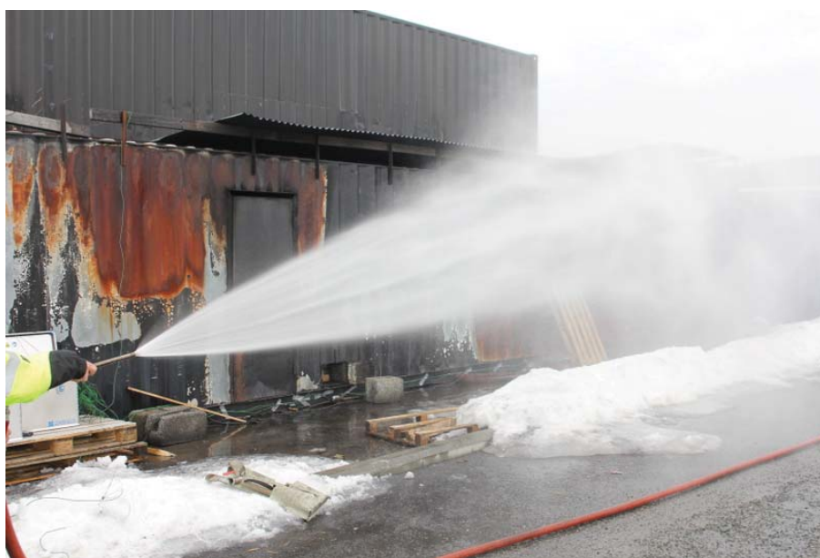
Figur 5-8 Demonstrasjon av sløkkespiker (attack) i friluft. Kastelengden er kortere og strålen er bredere enn for skjærslokkeren.
