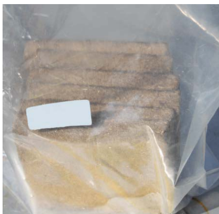
Figur 5-21 Tennkilden besto av 6 firkantede biter av trefiberplater med asfaltbelegg i en pose med 4 dl heptan tilsatt. Mesteparten av heptanen trakk inn i asfaltplatene.
