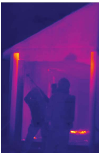
Figur B-21 IR-kamera blir brukt for å finne de gjenværende varme sonene i konstruksjonen.
