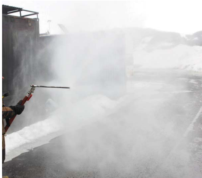
Figur 5-9 Demonstrasjon av sløkkespiker (begrensning) i friluft. Strålen danner en paraply, slik at den kaster både til siden og framover. Kastelengden er svært begrenset.
