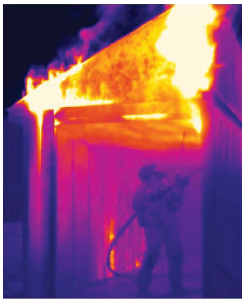
Figur B-10 Test 2B – Det ble benyttet borr sammen med en spredningslans for å komme til med skum i hulrommene. Å borre i røyken, for deretter
