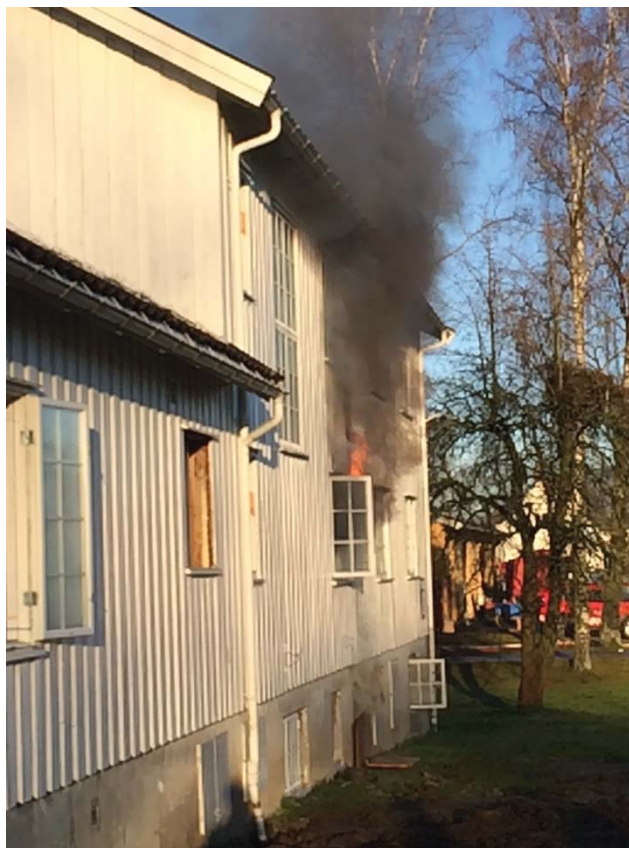
Figur A-3 Brann i test 3. Flammene står ut gjennom et åpent vindu og står i fare for å spre seg langs ytterkledningen.
