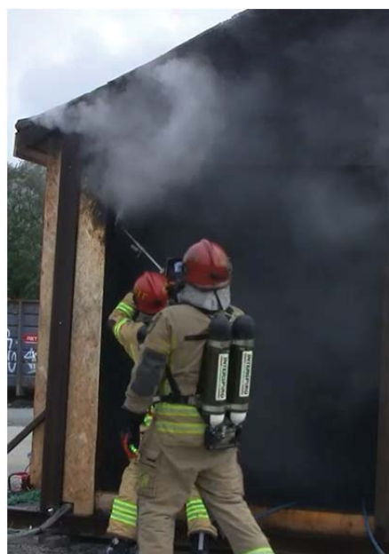
Figur B-21 IR-kamera blir brukt for å finne de gjenværende varme sonene i konstruksjonen.
