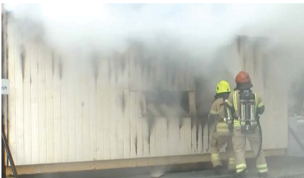
Figur B-8 Test 4A – Motorsaga har nettopp blitt brukt til å skjære ut et stort felt i området hvor det er varmest. Ved å åpne opp der hvor det er varmest får man god tilgang til å slokke raskt. En ulempe kan være at man får mer luft inn. I dette tilfellet var ikke dette et problem.
