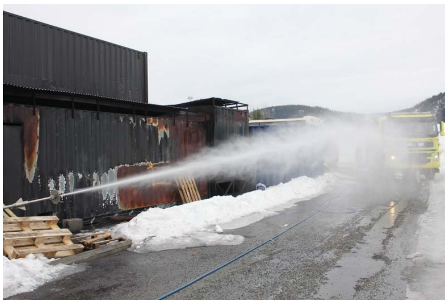
Figur 5-7 Demonstrasjon av skjærslokkeren i friluft. Kastelengden er omtrent like lang som en kontainerlengde.
