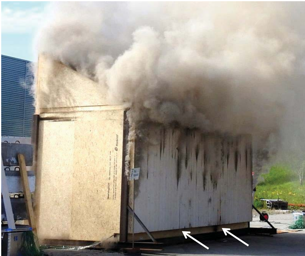
Figur 5-22 Slik så brannscenario A ut etter ca. 6 minutter. Pilene viser hvor tennkildene var plassert.
