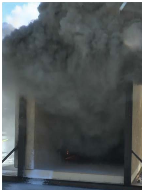
Figur B-9 Test 2B – Brannscenario før start slokking. Små synlige flammer nede på veggen er en god indikator på hvor brannen befinner seg bak veggen.
