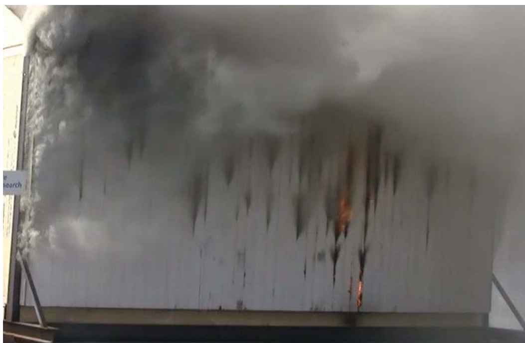
Figur B-4 Test 3A – Slik så brannen ut før skjærslokkeren ble tatt i bruk. De varmeste plassene er godt synlig med det blotte øyet.
