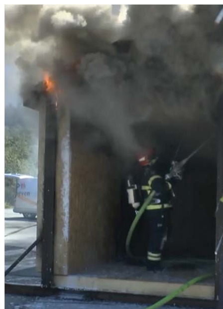
Figur B-10 Test 2B – Det ble benyttet borr sammen med en spredningslans for å komme til med skum i hulrommene. Å borre i røyken, for deretter
