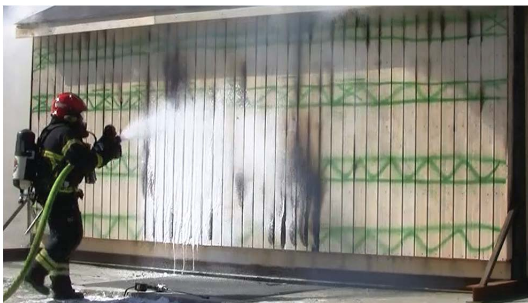
Figur B-2 Test 2A – Etter at synlige flammer var borte, ble det brukt to teknikker for å finne ut hvor det fortsatt var brann / varme. Den første metoden er å skumlegge veggen. Der skummet forsvinner raskest er det varmest. Den andre metoden er å bruke IR-kamera aktivt. På det øverste bildet ser man tydelig hvor det er varmest.
