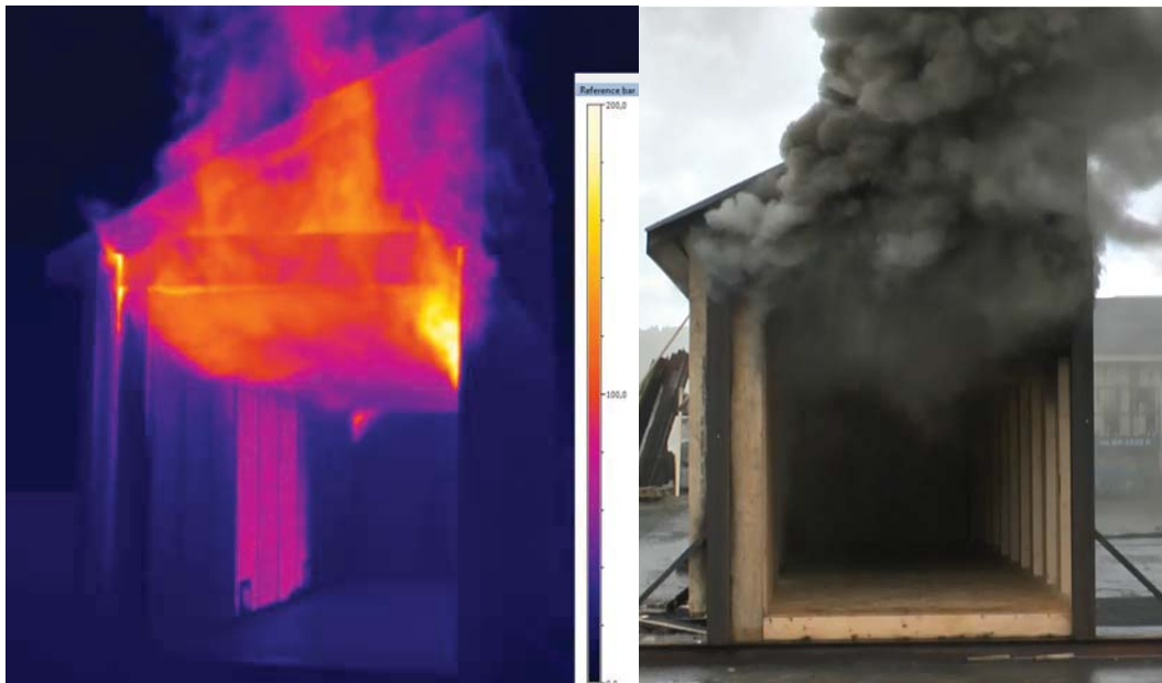
Figur B-15 Test 4B – Brannscenario før start slokking. Bildene er tatt like før brannvesenet starter slokking. IR kamera viser godt at det brenner inne i vegg , mens det på ekte er svært vanskelig å se.
