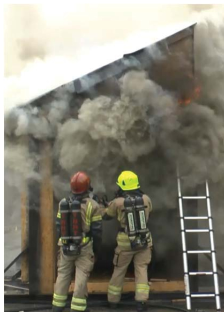
Figur B-18 Test 4B – Brannvesenet har ikke klart å ta ned brannen i hulrommet tilstrekkelig, og den sprer seg opp på loftet. Dette vises godt på IR-kameraet. Mengden røyk i korridoren gjør det nå nesten umulig å bruke motorsag der.
