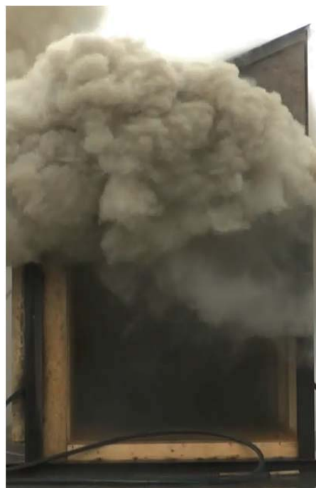
Figur B-17 Test 4B – Brannvesenet har fortsatt ikke innsett at det brenner i veggen. Det ble forsøkt sage et hull i taket ved hjelp av motorsag og stige, men pga. av all røyken ble motorsaga kvelt. Når røyken har sjiktet seg igjen er det igjen mulig å se at det brenner bak veggen ved hjelp av IR-kameraet.
