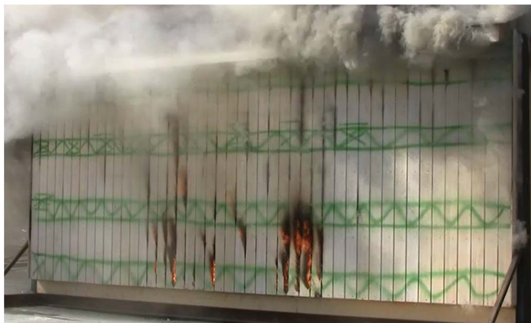
Figur B-1 Test 2A – Brannscenario før start slokking. Her var det lett å se hvor brannen var kraftigst, også med det blotte øyet. IR-kamera ble derfor mer viktig i etterslokkingsarbeidet.
