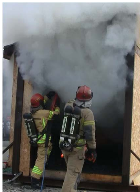
Figur B-20 Brannen ble raskt brakt under kontroll. Den grå røyken er primært vann som har fordampet.
