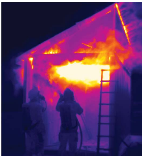
Figur B-18 Test 4B – Brannvesenet har ikke klart å ta ned brannen i hulrommet tilstrekkelig, og den sprer seg opp på loftet. Dette vises godt på IR-kameraet. Mengden røyk i korridoren gjør det nå nesten umulig å bruke motorsag der.
