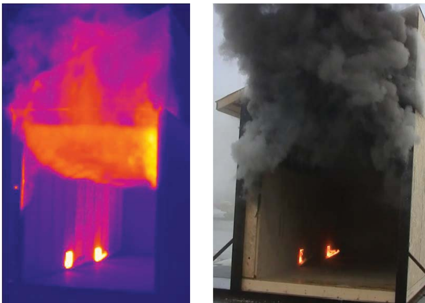
Figur B-22 Brannen like før slokking ble iverksatt. På grunn av noe tregt brannforløp ble det åpnet opp luker for å gi litt ekstra luft. Brannvesenet fikk ikke slokke gjennom disse åpningene.
