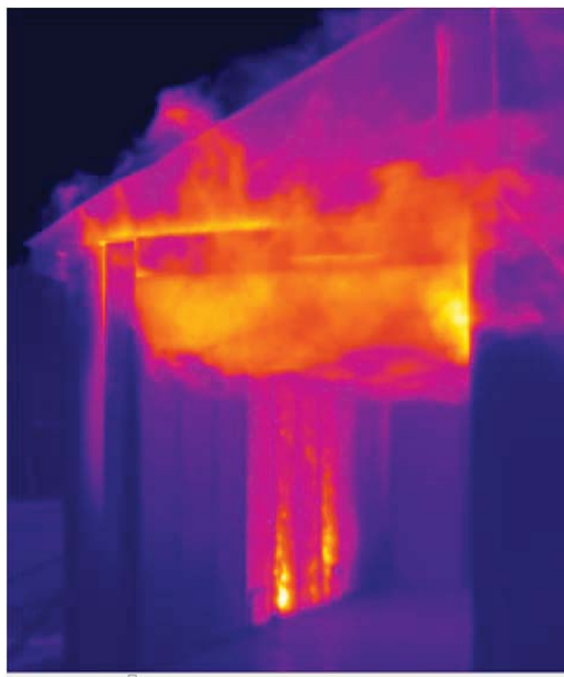
Figur B-9 Test 2B – Brannscenario før start slokking. Små synlige flammer nede på veggen er en god indikator på hvor brannen befinner seg bak veggen.
