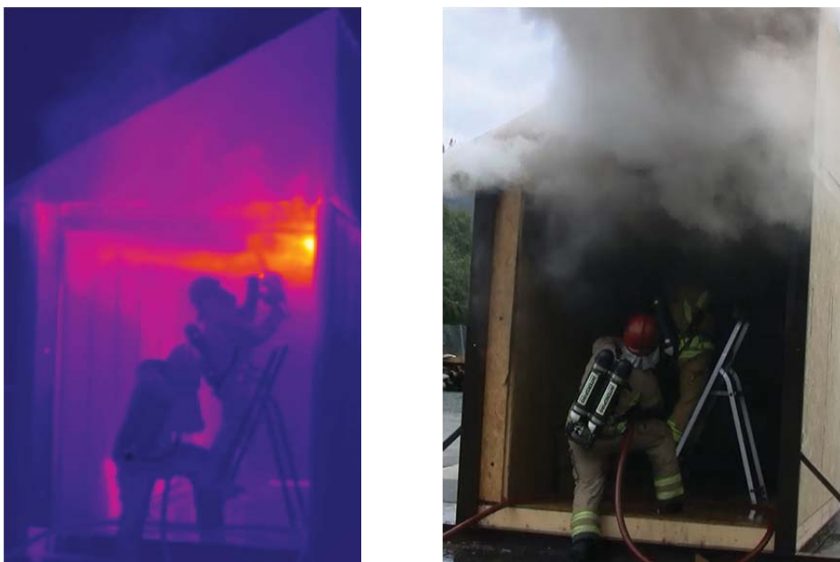
Figur B-25 På grunn av mye mindre røyk tett oppunder taket var det mulig å sage hull i det nedforede taket. Det ble også skjært hull opp til loftet for å kontrollere om brannen hadde spredt seg dit, og om den var slokket der.
