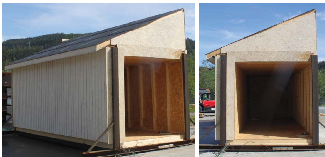
Figur 5-15 Testmodulen sett fra to ulike vinkler. Modulen var lukket bortsett fra korridoren, som var åpen i en ende.
