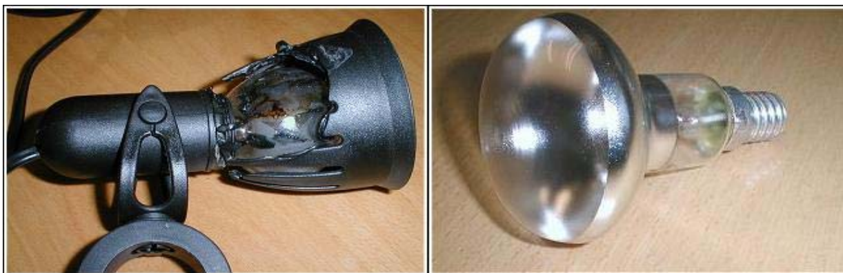
Figur 3.1: Bildet til venstre viser et spotlight beregnet for reflektorpære. De termiske skadene skyldes at en vanlig pære ble brukt i stedet for en reflektorpære.
