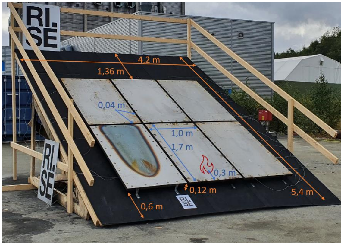
Figur 4-4 Storskala forsøksoppsett med takflate 4,2 m bredde x 5,4 m lengde og 30° takvinkel. 6 simulerte solcellemodular i stål er montert 12 cm over takoverflata. Startbrannen var plassert 0,3 m inn under midten av solcellemodulen nedst i midten, som markert på bildet.
