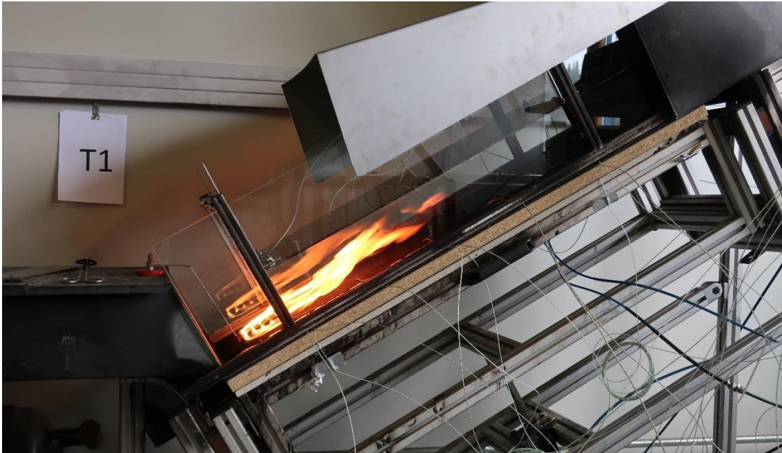
Figur 4-1: Forsøksoppsettet som er brukt til forsøka i liten skala. Dette er basert på utstyret som er skildra i CEN/TS 1187, testmetode 2 [10], med tillegg av ei stålplate som skal simulere ein solcellemodul plassert over takoverflata. Biletet er tatt under eit forsøk med solcellemodulen plassert 12 cm over takoverflata, og med ein vindstyrke på 2 m/s.
