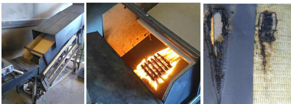
Figur 1-1 Testoppsett, testgjennomføring og skadeomfang etter test, fra masteroppgave av Smeplass [9].
