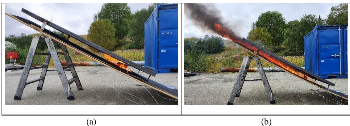
Figur 4-3 Brannen i forsøket med UL-krybbe og solcellemodul. Bilde (a) er teke omkring 4 minutt etter forsøksstart og viser brannen i trekrybba før den har spreidd seg oppover takoverflata. Bilde (b) er teke omkring 16 minutt etter forsøksstart, og viser brannen då den hadde spreidd seg oppover heile lengda av takoverflata
