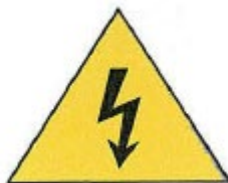
Figur 3-10 NEK 400:2018 stiller krav om at alle steder på DC-siden av en solcelleinstallasjon hvor det er tilgang til spenningsførende deler skal merkes med dette symbolet, og at delene kan være spenningsatt selv etter frakobling. Figuren er hentet fra NEK 400:2018 [14].
