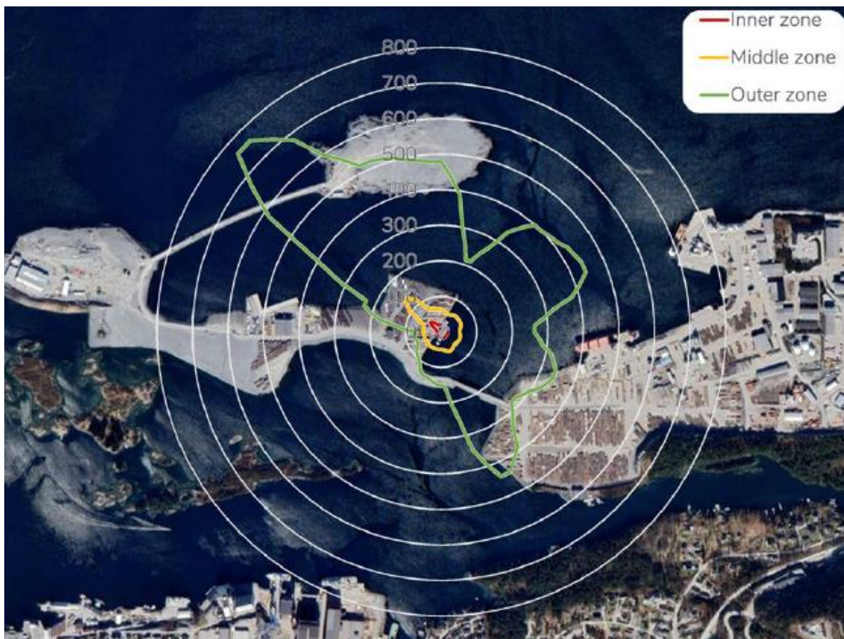
Figur 1: Risikokonturer for det omsøkte bunkringsanlegget.
